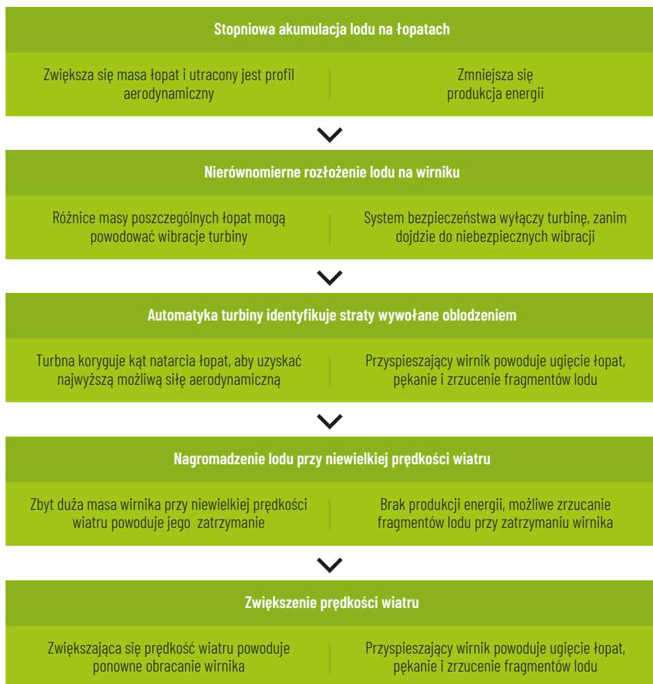
Rys. 4. Schemat reakcji standardowo wyposażonej turbiny wiatrowej na wystąpienie oblodzenia.
